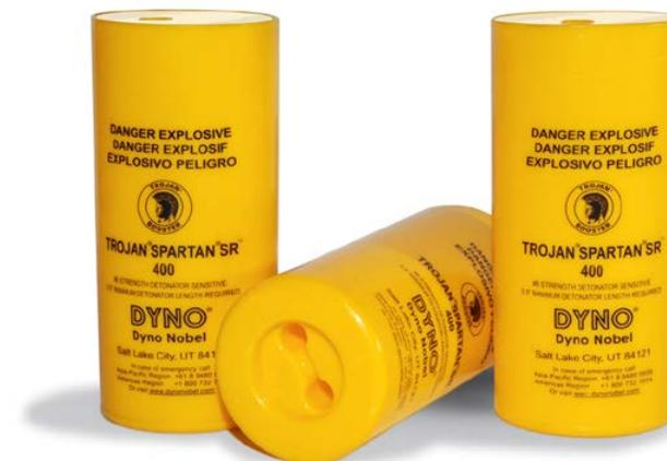
Además del pozo del detonador y del túnel, el reforzador TROJAN SPARTAN SR (resistente a choques) cuenta con una manga interna para proteger el tablero de circuito de los detonadores electrónicos y está diseñado específicamente para utilizarse con los detonadores electrónicos de Dyno Nobel DigiShot®, DigiShot® Plus, SmartShot™ y DigiShot® Plus 4G.
